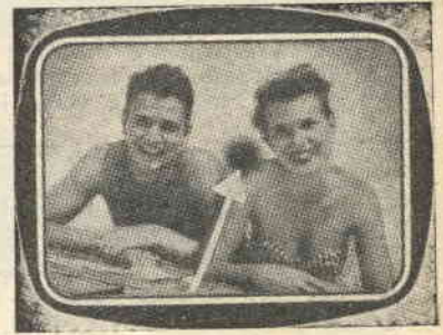
Fig. 2. — Nei televisori di vecchio tipo, sprovvisti di trappola ionica, il primo indizio della cosiddetta bruciatura ionica si aveva dal punto nero che appare al centro di questo quadrante e che si andava man mano ampliando.
